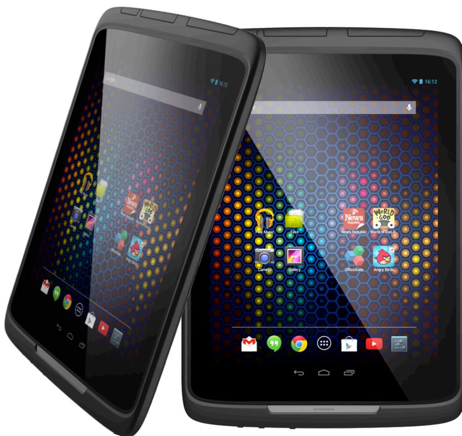
Equippée d'un processeur Quad-Core 1.2 GHz permettant l'utilisation d'applications professionnelles et de connexions mobiles rapides, la tablette Fieldbook G1 fonctionne sous Android Jelly Bean, et permet d'accéder au Google Play store ainsi qu'à ses applications. Dotée de la 3G et du GPS assisté, elle possède également deux caméras, qui peuvent être utilisées pour documenter des interventions ou des processus de travail, par exemple.
